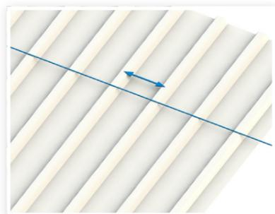
Colocar los siguientes puentes para chapa trapezoidal en las acanaladuras siguientes de manera que la **distancia X** se mantenga. La **distancia X** depende de la longitud del módulo + la anchura de sujeción (20 mm) + la distancia mínima respecto al extremo del puente correspondiente (20 mm).
