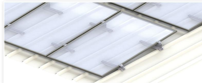
Monta el **juego de fijación Plus** en la parte exterior, en cada extremo de una fila de módulos, para prevenir que los adaptadores se salgan. Los adaptadores con los tornillos de fijación se deben colocar como mínimo a 20 mm del extremo del puente para chapa trapezoidal Plus correspondiente.
