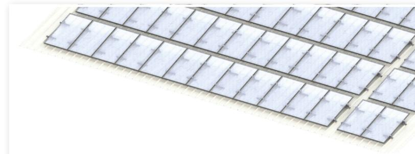
**Detalle:** separación térmica tras 12 m en sentido horizontal.
