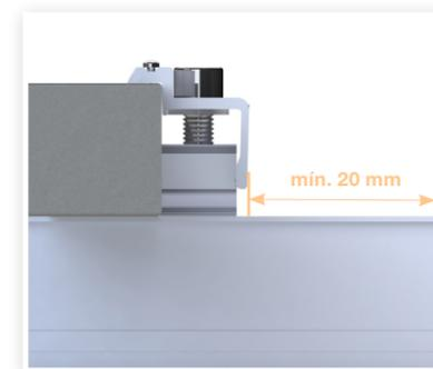
**Importante:** Las pinzas finales se deben colocar como mínimo a 20 mm del extremo del perfil de montaje correspondiente.
