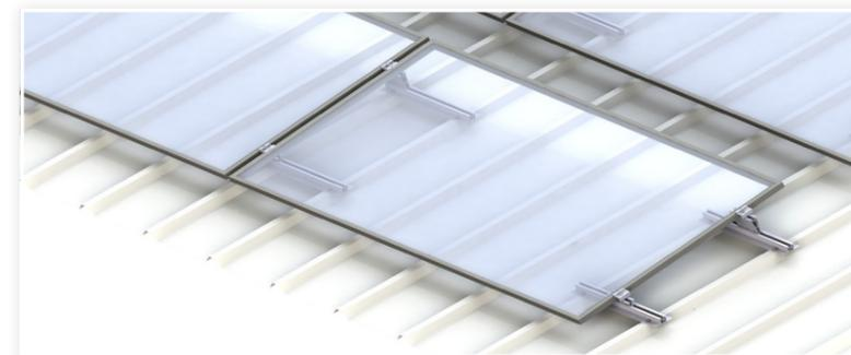
Monta el **juego de fijación Plus** en la parte exterior, en cada extremo de una fila de módulos, para prevenir que los adaptadores se salgan. Los adaptadores con los tornillos de fijación se deben colocar como mínimo a 20 mm del extremo del puente para chapa trapezoidal Plus correspondiente.
