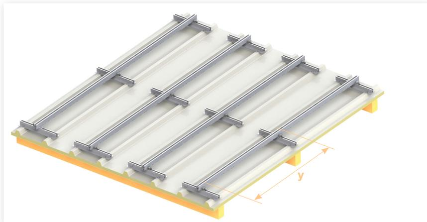
Colocar siempre el conector en cruz y los perfiles de soporte con una distancia suficiente respecto al extremo de los puentes para chapa trapezoidal. Los **conectores en cruz** se deben colocar **como mínimo a 20 mm** del extremo del puente para chapa trapezoidal Plus correspondiente.
