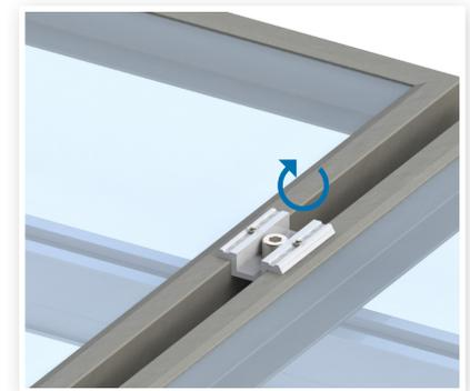
Montar el último módulo de cada fila de módulos con pinzas finales como se ha descrito antes. El montaje del resto de filas de módulos es igual.
