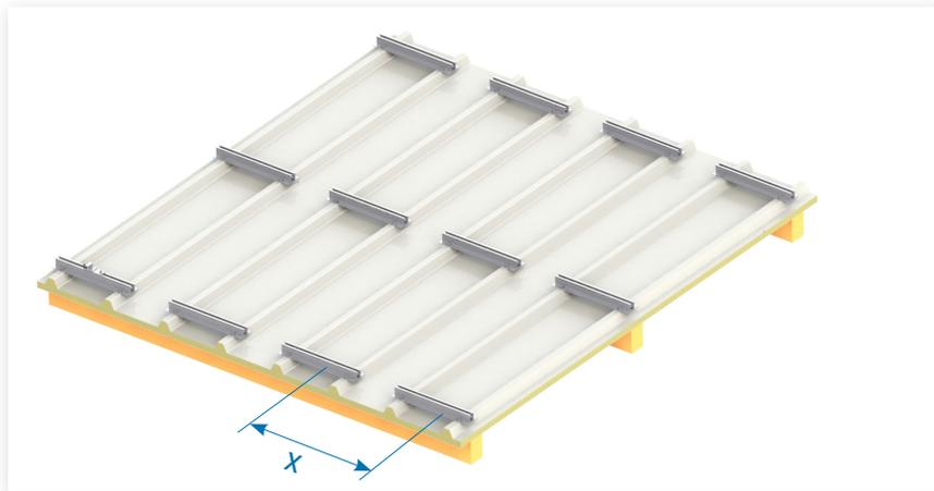
La **distancia Y** depende de las distancias entre correas. Comprueba siempre la **distancia entre correas** máxima posible para los perfiles de soporte de módulos elegidos en **Solar.Pro.Tool**.
